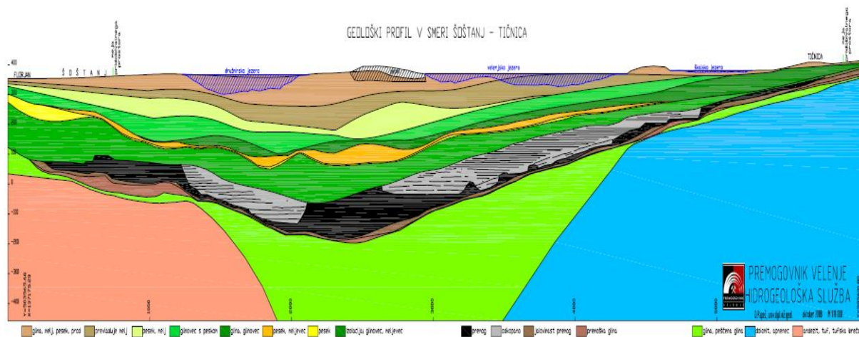
Slika 4: Geološki profil premoškega sloja v smeri Šoštanj - Tičnica Vir: Premogovnik Velenje
